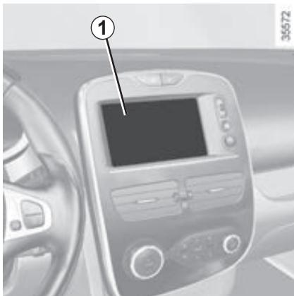
Если автомобиль оборудован таким дисплеем, система непрерывно отображает определенные технические данные в реальном времени на сенсорном мультимедийном экране **1**.
