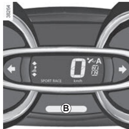
Вы можете изменить режим преждевременного оповещения этой сигнальной лампы. Для этого на одном из экранов multifunctional display нажмите «+», выберите «Car Setup», а затем «ShiftLight». Выберите режим о котором система будет вас предупреждать миганием сигнальной лампы с помощью кнопок **41**. Данная величина может быть установлена до 2000 об/мин ниже, чем максимально допустимые обороты двигателя.
