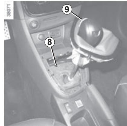
**В некоторых случаях**, если рычаг заблокирован в положении **P** при нажатой педали тормоза, его можно освободить вручную. Для этого следует снять основание рычага, поместить инструмент (твердый стержень) в паз **8** и, одновременно с этим, нажать кнопку **9** для разблокировки рычага. Срочно обратитесь на сервисную станцию компании-производителя.
